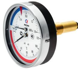
Корпус: сталь, цвет черный ■ IP40 ■ Стекло: минеральное ■ Механизм: медный сплав ■ Штуцер манометра: медный сплав ■ Шток термометра: нержавеющая сталь ■ Температура измеряемой среды: до +150 °С
