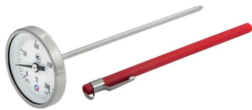
Корпус и шток (игла): нержавеющая сталь IP54 Стекло: органическое Чувствительный элемент: биметаллическая спираль Температура окружающей среды: -10...+60 °C Присоединение: шток в виде иглы
