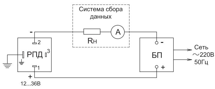
РПД - датчик давления измерительный гидростатический
