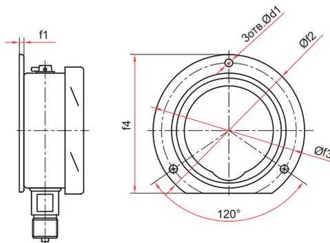
Радиальное присоединение с задним фланцем (Ø100, 150, 160 мм)
