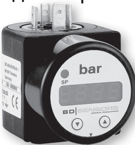
Устройство отображения PA 430 предназначено для всех типов датчиков давления с уровнем сигнала 4...20 мА и стандартом подключения DIN 43650. После подключения устройство сразу же готово к работе. Питание PA 430 осуществляется по токовой петле (4...20 мА). Дополнительного источника питания не требуется.
